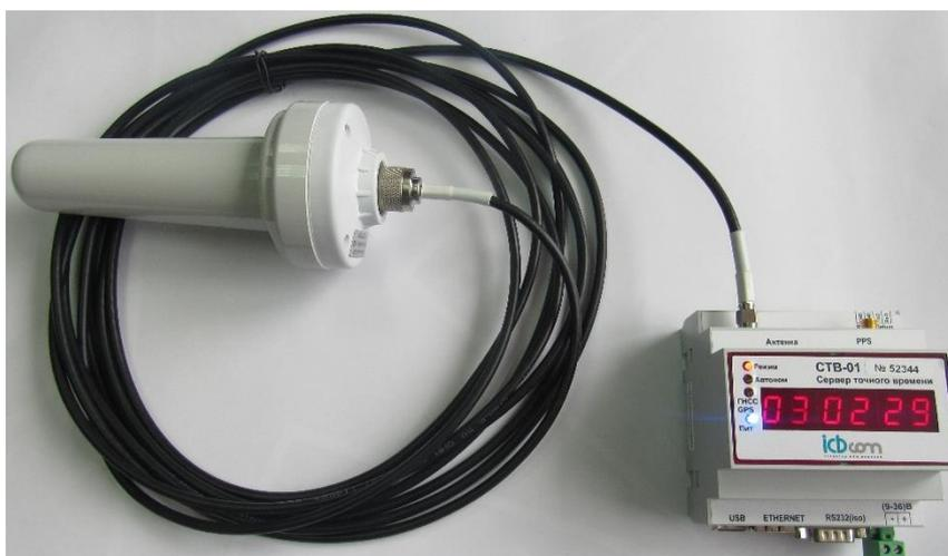
Рисунок1 - Общий вид СТВ-01 на DIN-рейку
